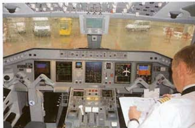
Su avanzada aviónica destaca por su sistema de mandos de vuelo Fly-by-wire y sus cinco pantallas de presentación Honeywell Primus Epic.
